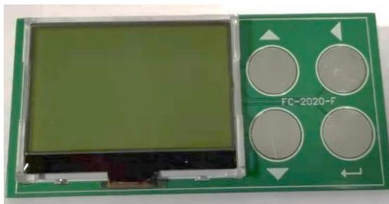
图3物料计数装置前面板图（代号：FX-2020-F）
