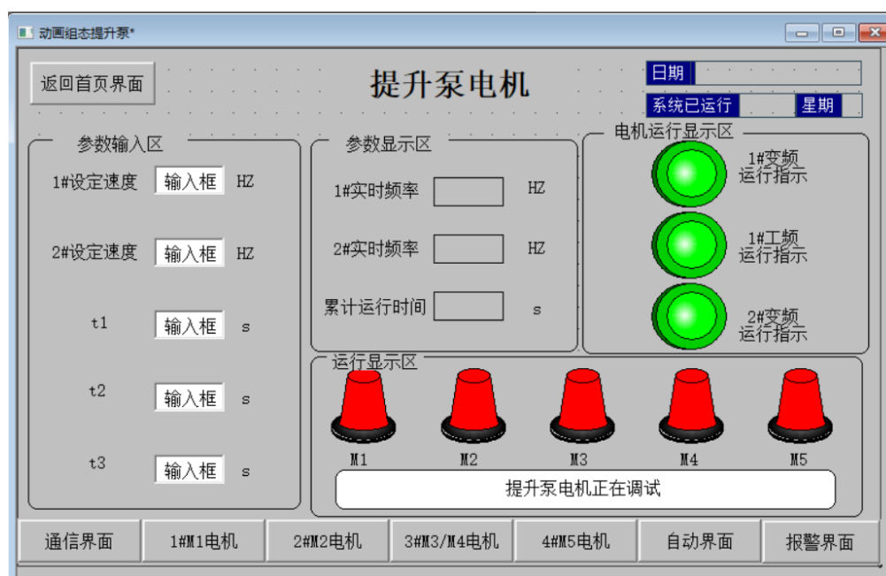
图9 提升泵调试画面
