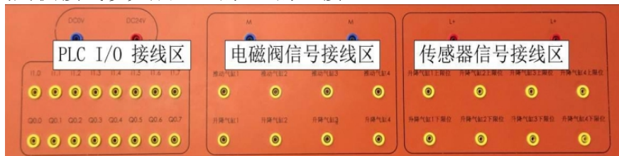
图 1-10 PLC 的 IO 信号接线区域
