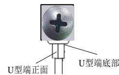
图5 U型冷压头与端子排连接示意图
